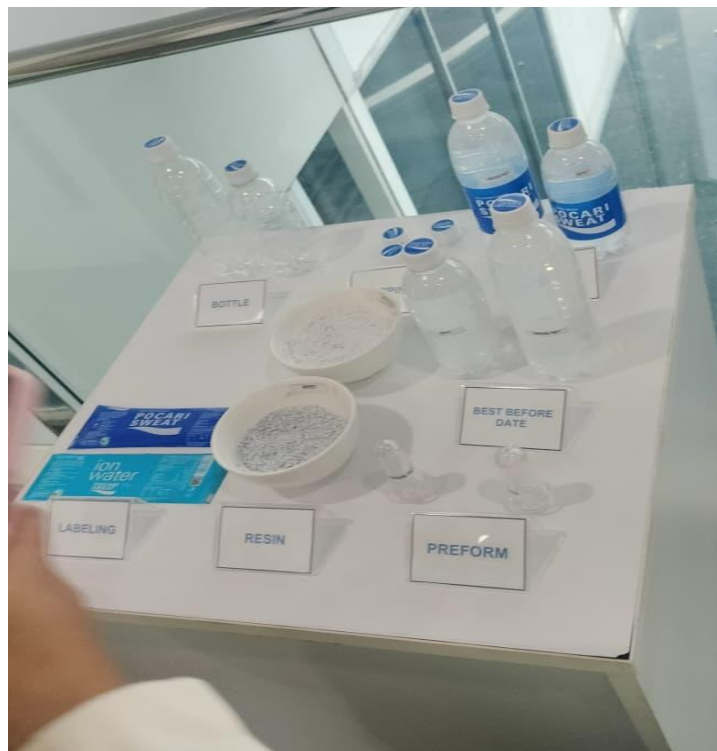
GAMBAR 3. Tahap produksi botol Pocari Sweat di area Pabrik PT Amerta Indah Otsuka (Dokumentasi Lapangan, 2025)
